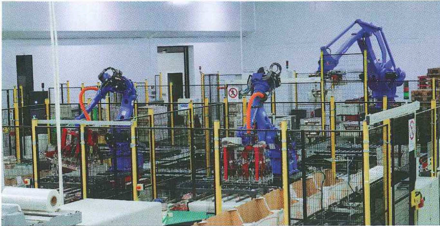
Esta solución robotizada de final de línea multiformato se basa en 3 robots Yaskawa, dos MPL80 y un MPL160.
